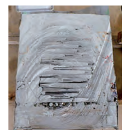
セメント固化されたドラム缶内部 (切断面の正面画像)
